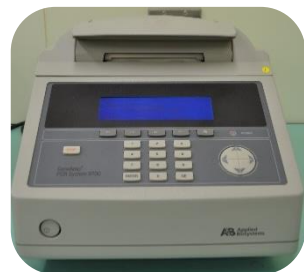
PCR装置 (抽出したDNAを増幅します。)
